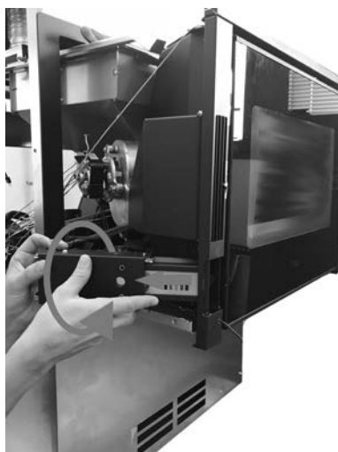
Fig. 89 - Gire la caja de la pantalla
