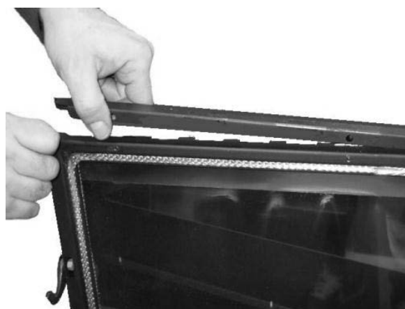
Fig. 109 - Extracción de los perfiles de la puerta
