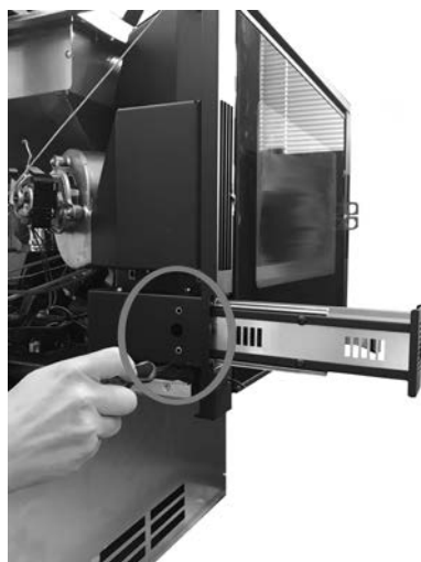
Fig. 90 - Fije los tornillos
