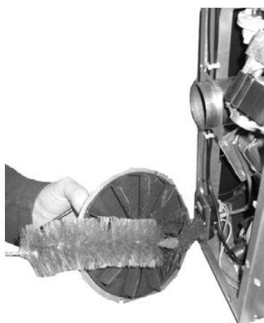
Fig. 106 - Limpieza del aspirador de humos: fase 1
