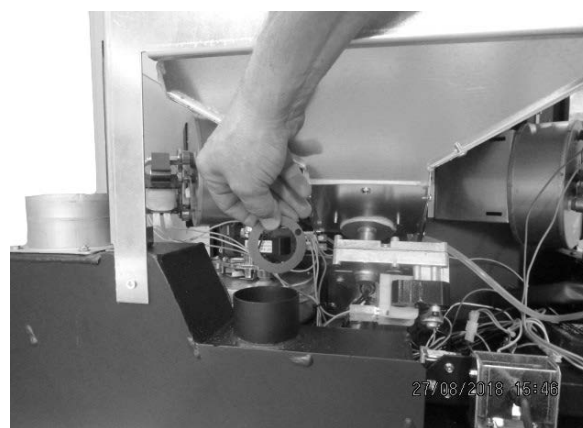
Fig. 37 - Extracción del anillo 2
