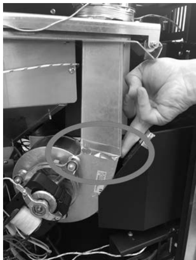
Fig. 54 - Selle con cinta adhesiva de aluminio
