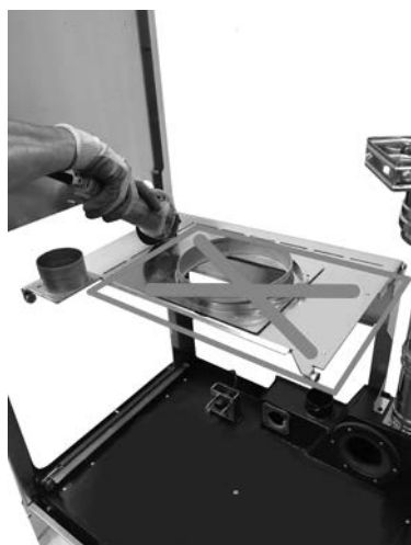
Fig. 67 - Cortar la tapa
