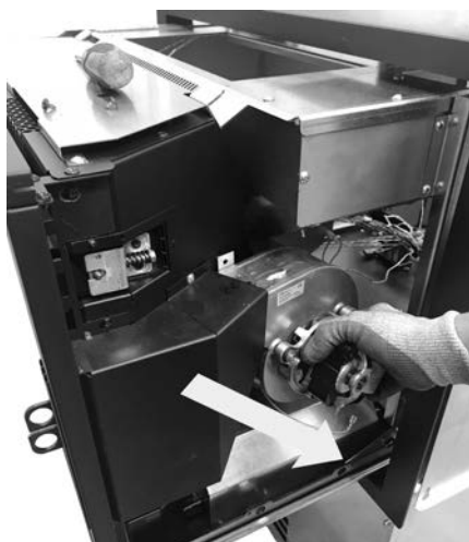
Fig. 104 - Extraiga el ventilador
