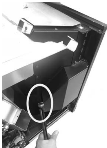
Fig. 46 - Rompa la esquina
