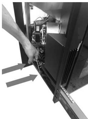
Fig. 31 - Extracción del cuerpo de la máquina
