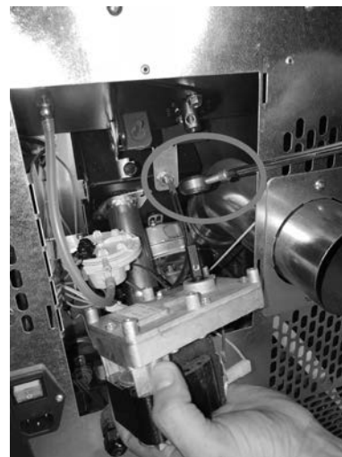
Fig. 98 - Extracción del motorreductor
