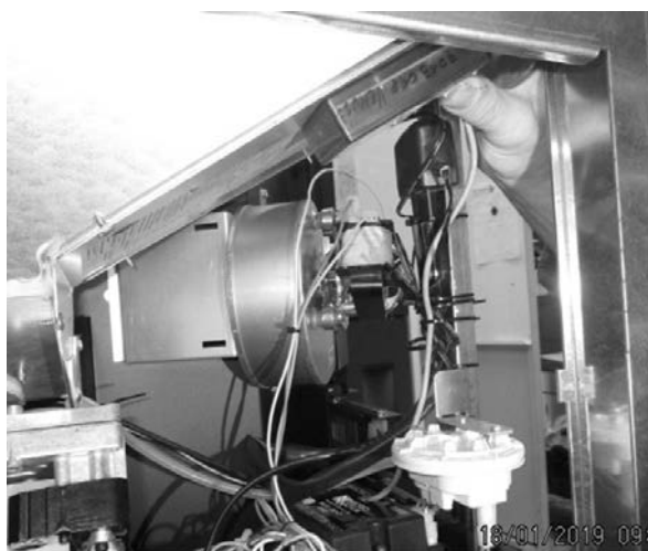
Fig. 95 - Fijación del módulo WI-FI
