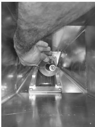
Fig. 99 - Extracción de la espiral
