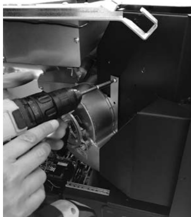
Fig. 45 - Extraiga el ventilador
