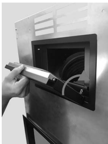
Fig. 76 - Introduzca la puerta en la trampilla
