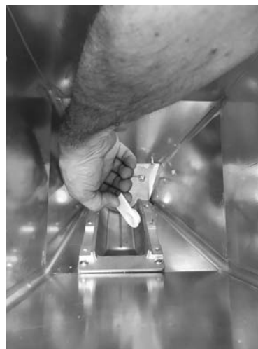
Fig. 100 - Extracción del cojinete
