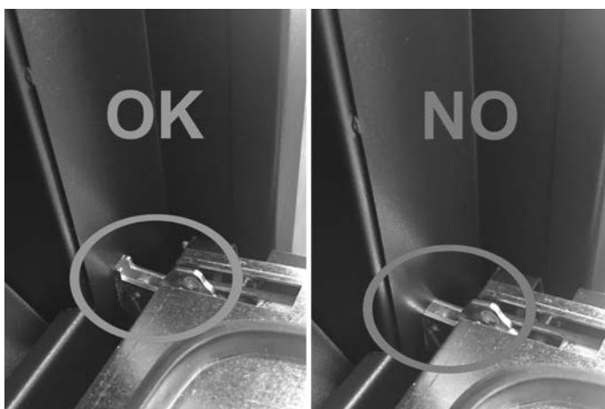
Fig. 77 - Enganche correcto de la bisagra
