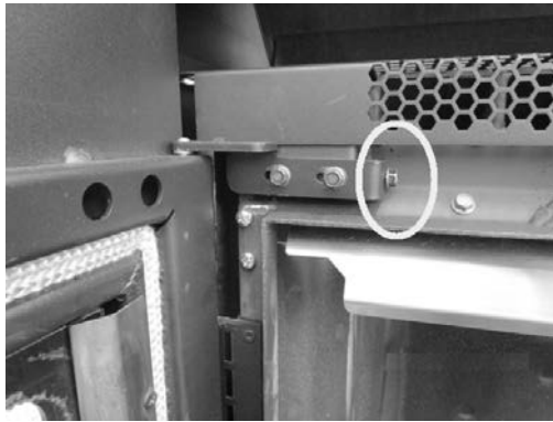
Fig. 34 - Regulación de la puerta
